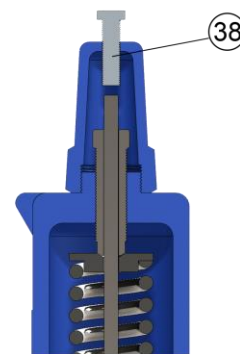
CONSTRUCCIÓN CON MORDAZA DE PRUEBA
