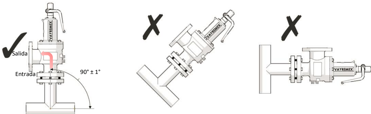
Fig. 6 Posición y orientación correcta de una VRP.
